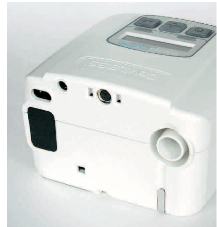
Rückseite mit Filter, Patientenschlauchanschluss und COM Anschluss
